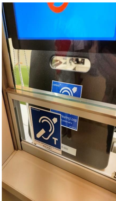
Zdjęcie nr 44: przenośna pętla indukcyjna
