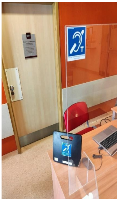
Zdjęcie nr 45: przenośna pętla indukcyjna
