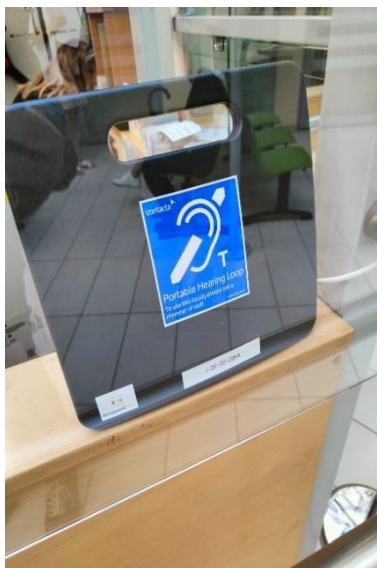
Zdjęcie nr 47: przenośna pętla indukcyjna
